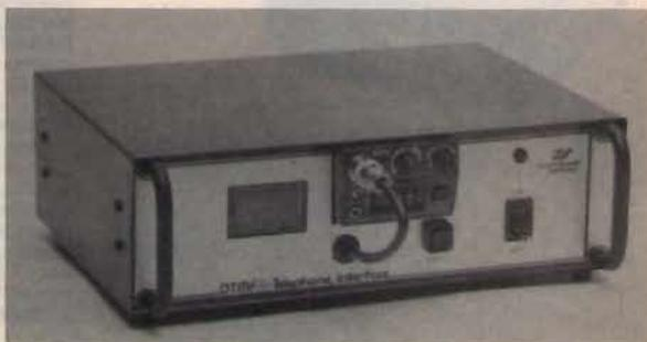
Con l'interfaccia telefonica DTMF potete ricevere o effettuare telefonate a distanza dalla base (casa, ufficio, laboratorio, ecc.) con un'unità portatile o veicolare.
